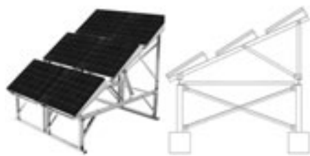
積雪地に効果的な逆段差架台
